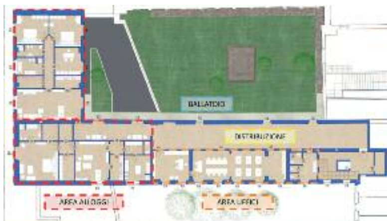
Progetto di recupero del primo piano: Layout delle aree funzionali. Individuazione dei locali adibiti ad uffici e sala riunioni/didattica, dei servizi igienici, degli alloggi parrocchiali e degli spazi distributivi (corridoio e collegamenti verticali: scale e piattaforma elevatrice).
